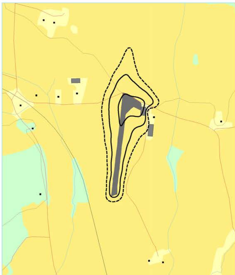
Figur 10-1. Kartleggingsgrenser i henhold til forurensningsforskriften. Kotene viser L_{Aeq,24h} 51 (stiplet), 54 og 61 dBA. Målestokk 1:10 000.
